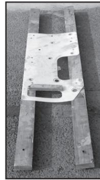
Example Concrete Template Chassis base & conduit
