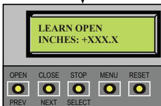
Mantenga presionado el botón OPEN (ABRIR) hasta que la puerta se deslice hasta estar completamente abierta. Libere el botón OPEN (ABRIR). Observe que si excede el recorrido, puede presionar CLOSE (CERRAR) para revertir la dirección. Presione STOP (PARAR) dos veces para guardar en la memoria la ubicación de parada al abrir.
